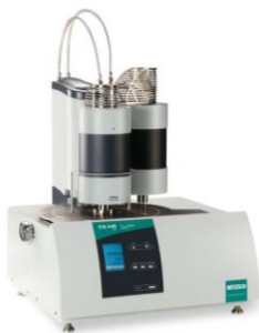
Fig. 2. STA 449 F3 Jupiter (Netzsch) apparatus [15]
